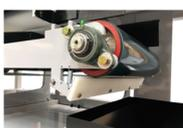
Su construcción robusta lo hace apto para operar con los más variados productos y un amplio rango de caudales de dosificación. A diferencia de los dosificadores por impacto y por tornillo, este equipo no ve afectada su precisión por productos con granulometría dispar o de grandes piezas.
