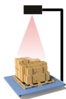
Diseñado para medición de volumen y peso de forma estacionaria de los distintos artículos en almacenes, recepción de carga o despacho. Esta información es recolectada digitalmente y puede ser enviada a su sistema de gestión de depósito. Los rangos de medición pueden ir desde un paquete pequeño hasta un pallet entero con total versatilidad, de acuerdo al requerimiento del cliente
