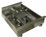
La línea de plataformas PSS está instrumentada con una celda de carga monoplato sellada herméticamente y construida en acero inoxidable. El material de construcción de toda la plataforma es acero inoxidable. Su diseño reforzado le permite desempeñarse exitosamente en todo
