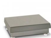
Balanza de plataforma para uso industrial en ambientes sanitarios o corrosivos. Con rango de operación entre 3 kg y 100 kg. Construida totalmente en acero inoxidable y sellada herméticamente. Plataforma con dispositivo para amortiguación de impactos que protege la celda de carga.
