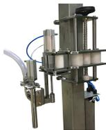
Sistema semiautomático para llenado de bidones y tambores. Permite trabajar con líquidos no espumantes, con distintos grados de fluides y densidad, apta para productos corrosivos e inflamables. Cuenta con regulación automática del caudal de dosificación de la bomba de alimentación, para cortes grueso y fino de ajuste. El controlador ITW 380 almacena en su memoria los seteos para distintos productos y
