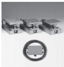
Cada apoyo está instrumentado con celdas de carga tipo viga simple modelo SQB en sus variantes de acero niquelado o acero inoxidable, y sellados herméticos IP67 ó IP68. Los soportes de montaje pueden estar contruidos en acero con terminación pintada en epoxi o acero inoxidable.
