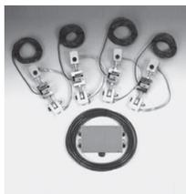
Cada punto de sostén está instrumentado con celdas de carga tipo S de tracción / compresión modelo PST en sus variantes de acero niquelado o acero inoxidable, y sellados herméticos IP67 ó IP68; pudiendo ser un montaje apoyado o colgado. Los soportes de sostén pueden estar contruidos en acero con terminación pintada en epoxi o acero inoxidable, e incluir rótulas para alineación de la carga.
