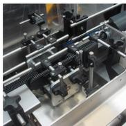
La controladora dinámica de peso con transportador a cadena Check 380 tiene un rango de operación entre 500 gr y 20 kg, con resoluciones de lectura entre 1 y 10 gr.
