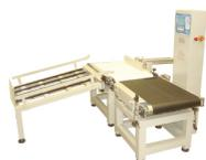
El rango de la línea de checkweigher de alta capacidad varía entre 30 y 100 Kg, con resoluciones de lectura entre 10 gr y 50 gr. Especialmente pueden fabricarse equipos de mayor capacidad, para pallet con tambores u otras cargas.
