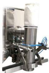
El operador, con un solo pulsador da inicio al dosificado del producto y el controlador ITW 380 se encarga de hacer los ajustes y cortes de acuerdo a los pesos preseteados, independizando al operador de toda decisión y asegurando la repetitividad de las pesadas
