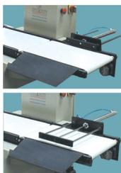
Tiene un sólo sentido de descarte, opera por accionamiento neumático. Cuenta con regulaciones de velocidad y fuerza de golpe para trabajar con variados productos sin afectarlos. De acuerdo a la capacidad del elemento a descartar, puede necesitar de guías, rodamientos lineales y bandas plásticas aptas para deslizamientos laterales.
