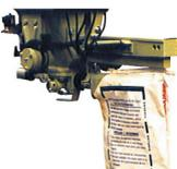
El operador, con un solo pulsador da inicio al dosificado del producto y el controlador ITW 380 se encarga de hacer los ajustes y cortes de acuerdo a los pesos preseteados, independizando al operador de toda decisión y asegurando la repititividad de las pesadas.
