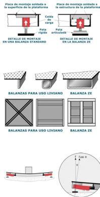
Para reducir al mínimo la flexión localizada de la celda de carga, la placa de montaje de la misma se conecta directamente a la estructura en vez de a la superficie de la plataforma. Las patas de apoyo poseen un diseño rotulado y están construidas en acero con insertos de neopren para disminuir el efecto de las vibraciones del suelo sobre la balanza, resultando en una exactitud superior.
