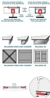
Para reducir al mínimo la flexión localizada de la celda de carga, la placa de montaje de la misma se conecta directamente a la estructura en vez de a la superficie de la plataforma. Las patas de apoyo poseen un diseño rotulado y están construidas en acero con insertos de neopren para disminuir el efecto de las vibraciones del suelo sobre la balanza, resultando en una exactitud superior.
