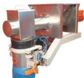
El operador, con un solo pulsador da inicio al dosificado del producto y el controlador ITW 380 se encarga de hacer los ajustes y cortes de acuerdo a los pesos preseleccionados, independizando al operador de toda decisión y asegurando la repetitividad de las pesadas.
