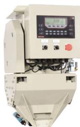
En la balanza embolsadora 100WG el operador, con un solo pulsador da inicio al dosificado del producto y el controlador 720i se encarga de hacer los ajustes y cortes de acuerdo a los pesos preseleccionados, independizando al usuario de toda decisión y asegurando la exactitud de las pesadas.
