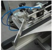
Este sistema permite clasificar por alto y por bajo los descartes. Se utiliza con productos que no admiten impactos o que pueden derramarse.
