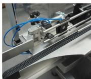
Cuenta con un brazo comandado neumáticamente desde la balanza, retirando el producto de la línea al peso con un suave movimiento de compañía. Permite clasificar y agrupar los descartes hacia un lado y hacia el otro de la línea.
