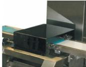
Construida en acrílico, protege al transportador contra corrientes de aire que puedan inestabilizar la balanza; y la aísla del contacto accidental del operador, que pueda dañar la celda de carga.
