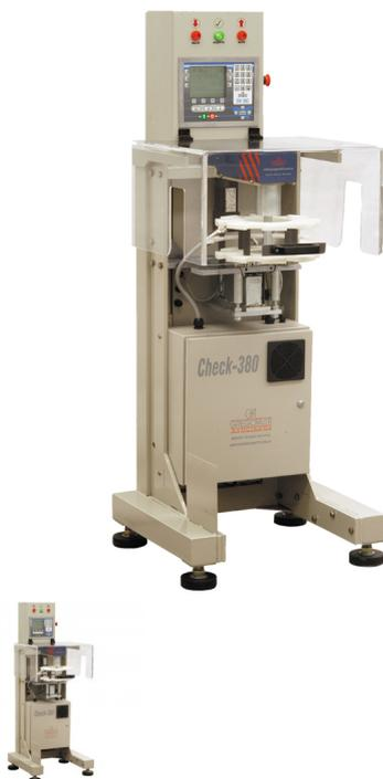
Chequeador dinámico de peso para envases de diámetro reducido, aerosoles y/o frascos verticales. Para incorporar en la línea de transporte sin reformas previas. No necesita espaciadores de producto en el ingreso.
