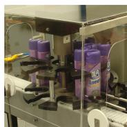
El checkweigher con sistema de transporte rotativo, permite el pesaje a alta velocidad de envases inestables. Los cambios de formato son simples, solamente requieren del cambio de estrella, el cuál insume apenas 15 minutos.
